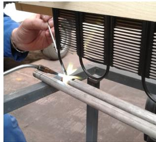
FIGURE 5 – Soudure des condenseurs aux collecteurs d'entrée et de sortie.
