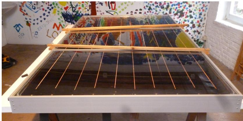
FIGURE 2 – Capteur solaire autoconstruit de la rue Voot. Réalisé en matériaux nobles (verre à faible teneur en fer, cuivre, aluminium).
