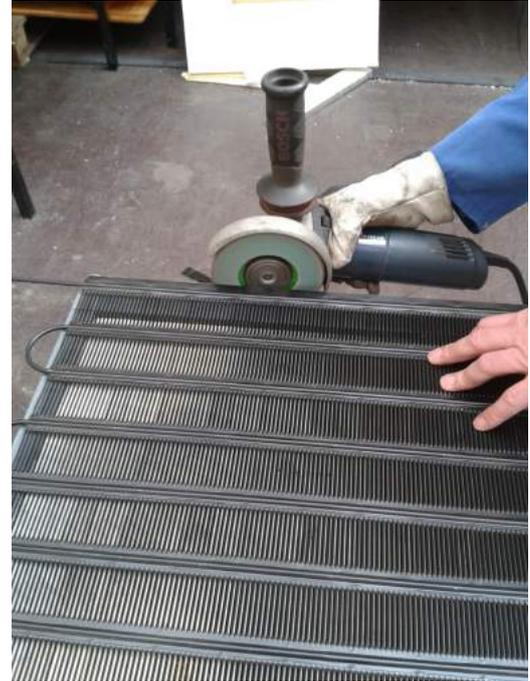
FIGURE 1.4 – Découpe des condenseurs pour obtenir les dimensions voulues afin qu'ils rentrent dans le cadre.
