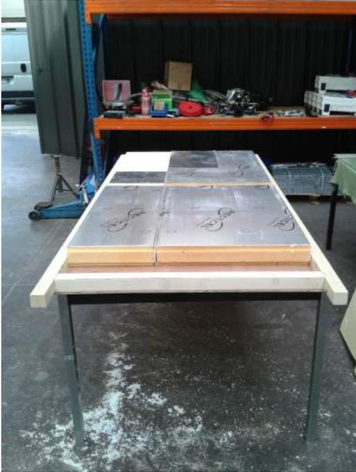
FIGURE 1.3 – Découpe et mise en place de l'isolant Recticel de 80 mm d'épaisseur.
