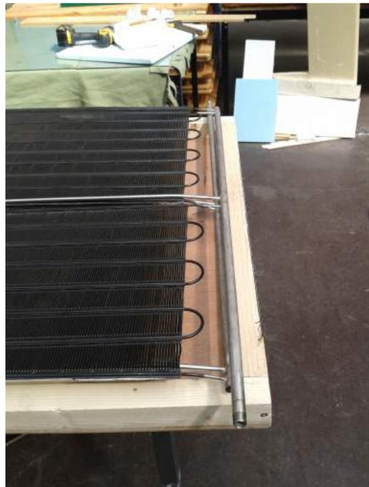
FIGURE 1.12 – Résultat des soudures. Vérification de l'étanchéité (OK).
