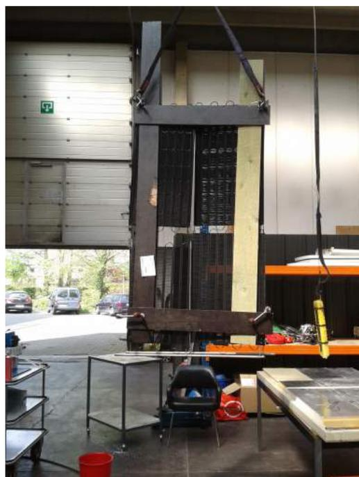
FIGURE 1.10 – Aménagement pour souder les quatre condenseurs aux collecteurs en même temps.
