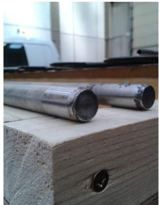
FIGURE 1.6 – Soudures d'un bouchon pour fermer une des extrémités des collecteurs.
