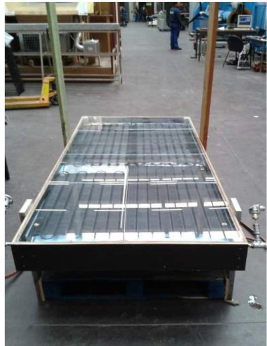
FIGURE 1.18 – Fixation du verre (en quatre morceaux) d'épaisseur 5 mm d'épaisseur grâce à du silicone transparent.
