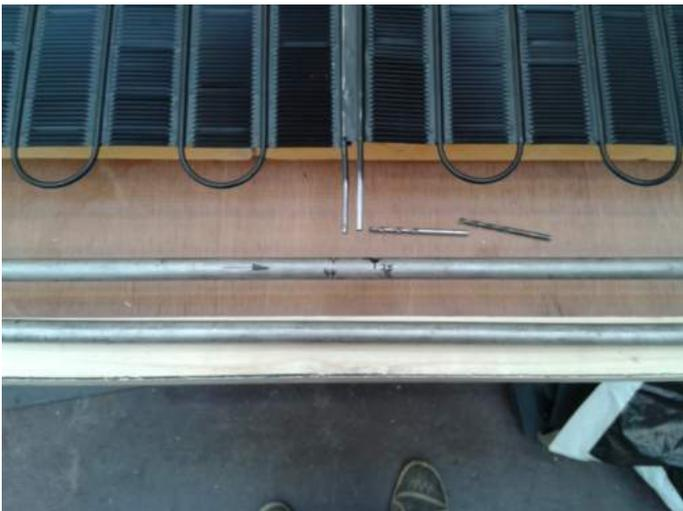
FIGURE 1.5 – Récupération de deux tuyaux en acier inoxydable de 9,4 mm de diamètre utilisées comme collecteurs + perce de trous pour les connections avec les condenseurs.
