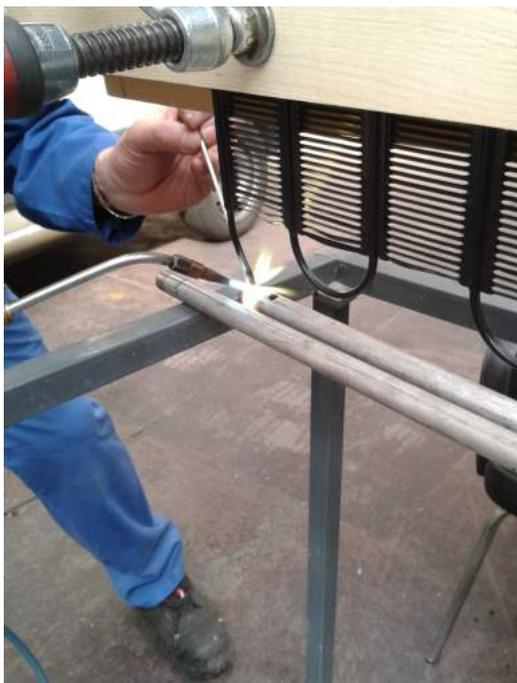
FIGURE 1.7 – Soudures des condenseurs du bas aux collecteurs. Soudures faites à l'argent mais aurait très pu être réalisées à l'étain-plomb.
