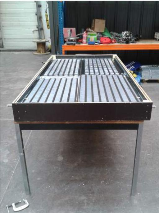
FIGURE 1.15 – Résultat du capteur avec les côtés fixés.
