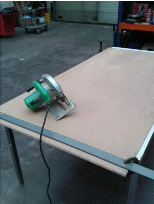
FIGURE 1.1 – Découpe de la planche arrière pour obtenir une surface de 1004 \* 2010 mm. Epaisseur de 12 mm.
